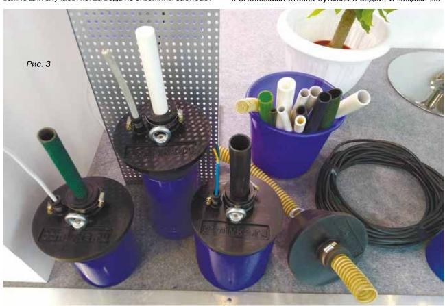
лающий мог проверить герметичность соединений, налив воду сверху в затянутые штуцера.
